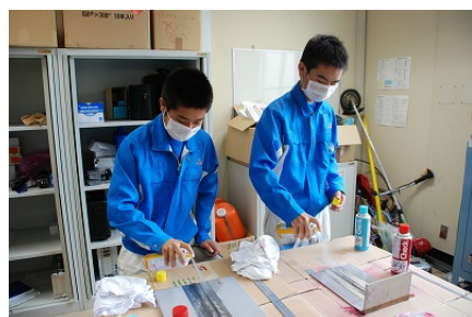
浸透探傷試験の様子
